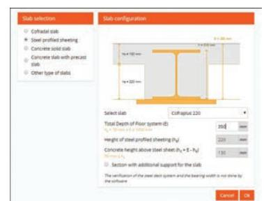
**CoSFB** est un logiciel de prédimensionnement pour poutrelles mixtes Slim-Floor (ABC est le logiciel pour les poutres non-mixtes Slim-Floor). Visitez notre site Web pour le téléchargement et les mises à jour récentes: [sections.arcelormittal.com](http://sections.arcelormittal.com) (Design aid)
