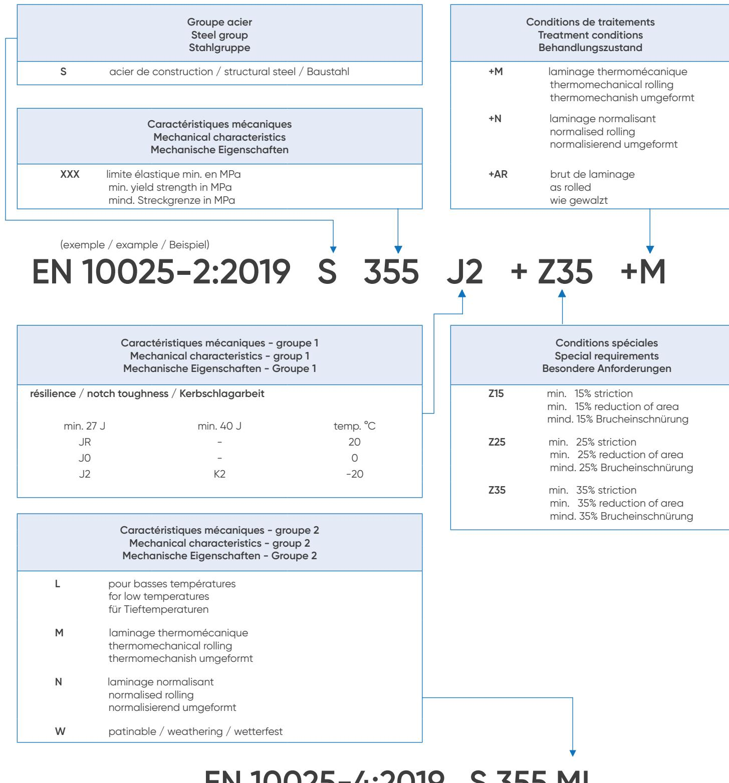
**Tableau 2** Aciers de construction non alliés suivant norme européenne
